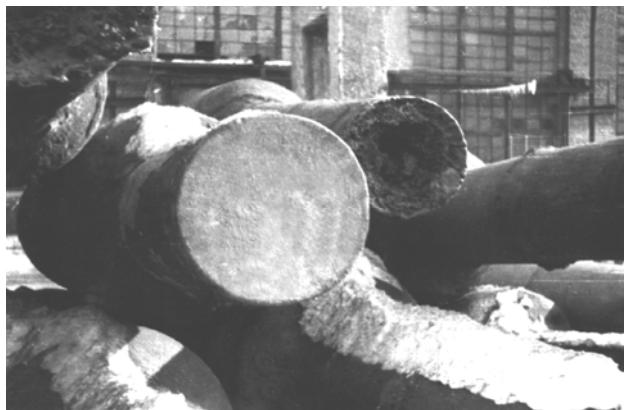
Рис. 4. Торец прибыли прокатного валка из высокопрочного чугуна массой 26000 кг, отлитого с комбинированным электродуговым-электрошлаковым обогревом прибыли, и валков, отлитых с утеплением древесным углем и двухразовой доливкой прибыли
